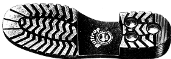
Bild 1: Sohle des Prüfschuhs (Typ "Picasso")
