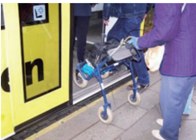
Abb.1 Restspalt- und Reststufenuntersuchung an Haltestellen des Erfurter Stadtbahnnetzes
