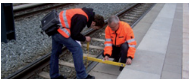
Abb.2-3 Restspalt- und Reststufenuntersuchung an Haltestellen des Erfurter Stadtbahnnetzes
