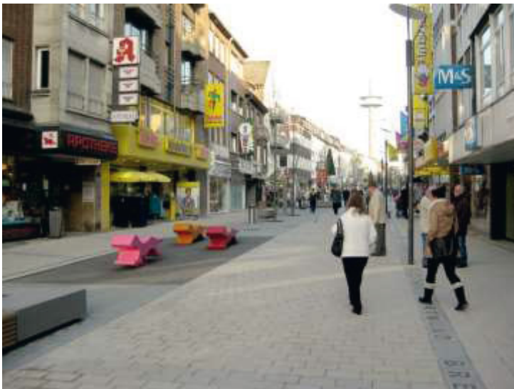
Abbildung 155: Fußgängerzone in Wesel mit Einrichtungsband und farblich abgesetztem Gehbereich
