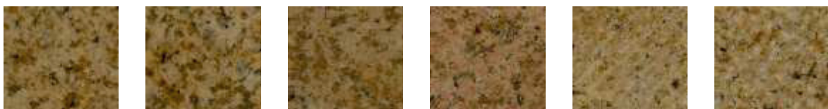
Abbildung 59: sechs Seiten eines Granitwürfels mit unterschiedlicher Oberflächenbearbeitung
