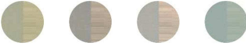
Abbildung 19: Zur Veranschaulichung des Einflusses sollen vier exemplarische Darstellungen für den Einfluss der Farbtemperaturen 2000 K, 4000 K, 5800 K und 12000 K (v.l.n.r.) auf eine Materialkombination dienen. Eigene Darstellung.
