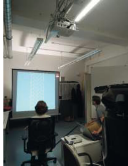
Abbildung 65. Testaufbau in Dresden, Betrachtungsabstand 2 m
