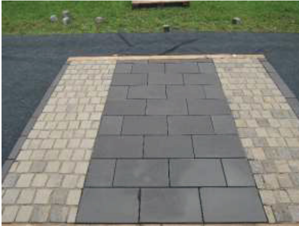
Vergleichsbild 2: 30 von 38 Nennungen der Probanden fielen auf den linken, gesägten Teststreifen, Teststreifen rechts: bruchrau
