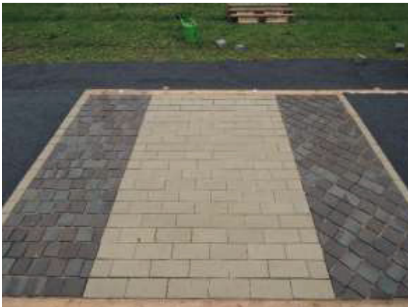
Vergleichsbild 1: 16 von 30 Nennungen für den Diagonalverband (rechts) Beide Teststreifen gesägt, mit Hell-Dunkel-Kontrast der Fugen
