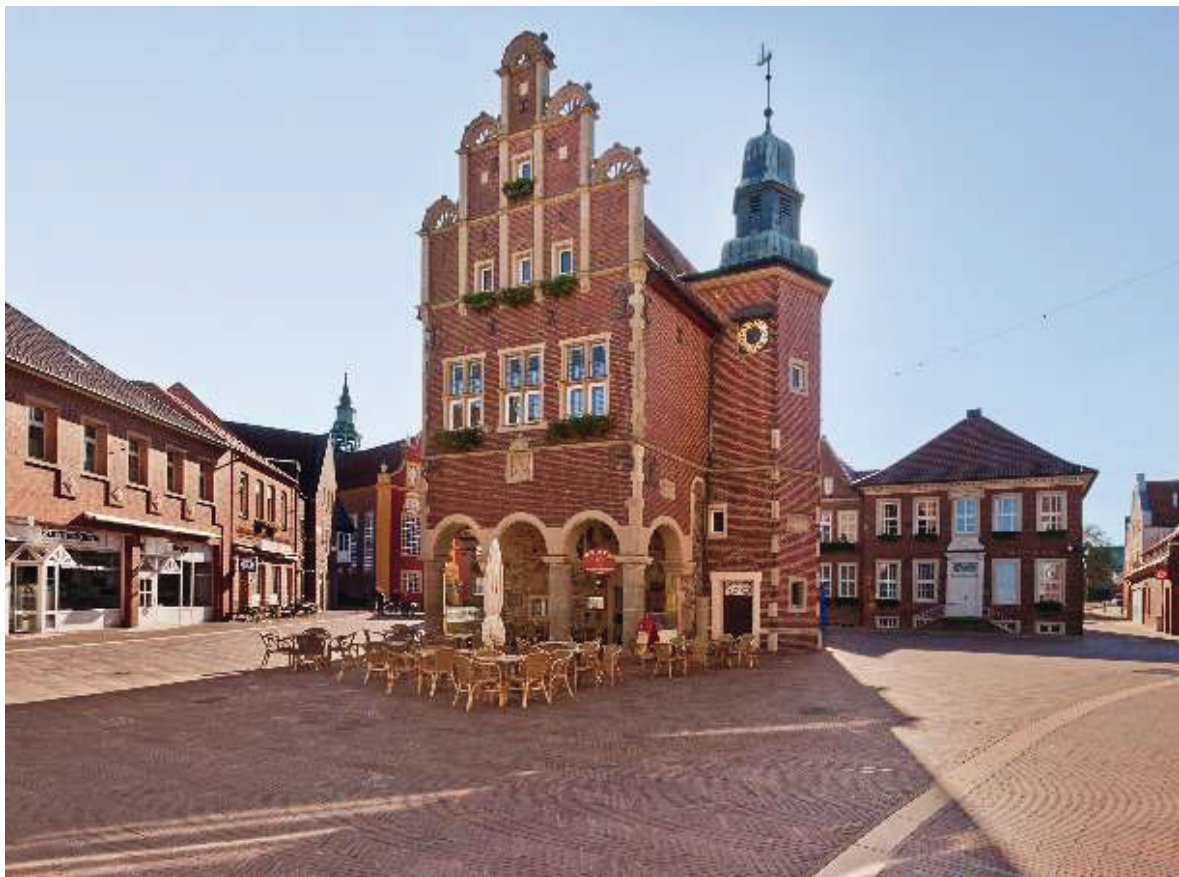
Abbildung 16: Fußgängerzone Meppen: Leitelement mit Helligkeitskontrast zum dunklen fugenreicher Klinker
